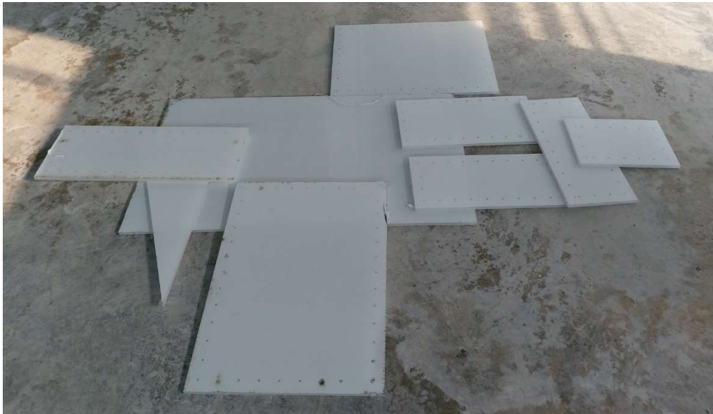
Figura 8. Piezas de Acrílico para OWC, espesor 12 mm
