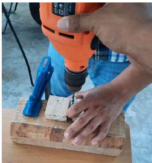
Figura 9. Perforación de las "L" de acrílico.
