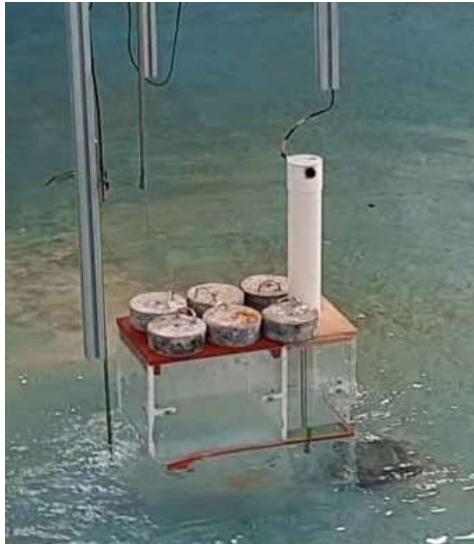
Figura 15. Presentación del sensor ubicado en la parte central del área de influencia en la Cámara OWC
