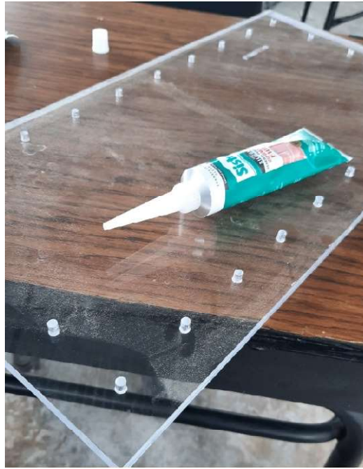
Figura 11. Sellado de perforaciones con silicón.
