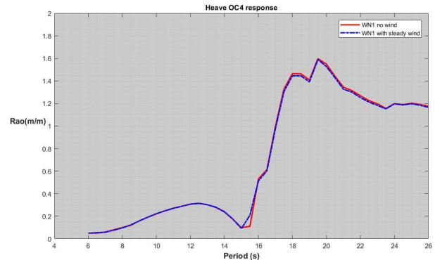
Figura 4. Movimiento ascendente y descendente (heave) de plataforma semisumergible bajo condiciones marítimas.
